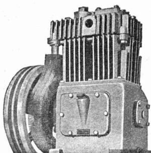
pour marche continue et de longue durée, à grande capacité de rendement, avec graissage par circulation forcée. Construction extrêmement solide. Modèles pour refroidissement par air et par eau. Capacité de rendement de 4 à 150 m<sup>3</sup>.
