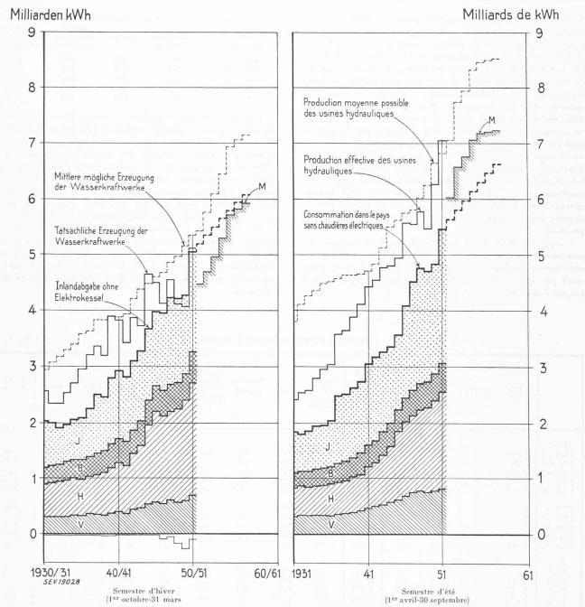
Fig. 1. — Production et consommation d'énergie depuis 1930/31 et pronostics pour les prochaines années.
