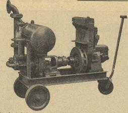
Débits de 1 à 500 litres/seconde. - Pas de soupape de pied, ni de clapet dans la tubulure d'aspiration. —
