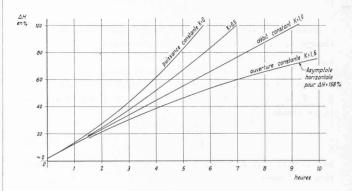
Fig. 6. — Application numérique. Canal infiniment long. Surélévation produite à l'extrémité aval, en fonction du temps, pour différents modes de réglage, à la suite d'une réduction de puissance de 20 %.
