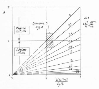
Fig. 7. — Canal de longueur finie. Stabilité du réglage.
