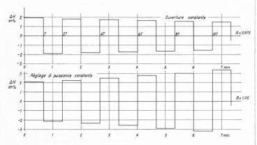
Fig. 9. — Application numérique. Canal de longueur finie. Surélévation consécutive à une réduction de puissance de 20 %, sans tenir compte des pertes de charge dans le canal.
