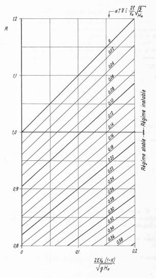
Fig. 8. — Canal de longueur finie. Stabilité du réglage. Domaine des cas usuels.
