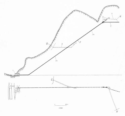
Fig. 5. — Centrale de Gondo. — Chambre d'équilibre et puits incliné.
