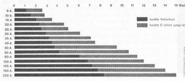
Fig. 1. — Perte en watts des fusibles D 6 — 200 A.
