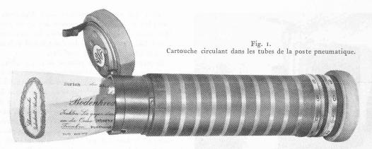
ches (fig. I) s'aiguillent elles-mêmes vers leur destination. On conçoit ainsi des installations complètement automatiques telles que celles installées par la *Standard Téléphone et Radio S. A.* Un avantage à signaler est celui de la facile extension d'une installation qui, primitivement n'utilisait que deux tubes convoyeurs. On peut sans difficulté aucune agrandir cette dernière en installant 4, 6 ou 8 circuits desservant chacun jusqu'à 20 stations.
