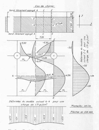
Fig. 3. — Essai d'une dalle-champignon sur modèle réduit. Moments effectifs dans la dalle pour une charge de 1  $m t/m^2$ .
