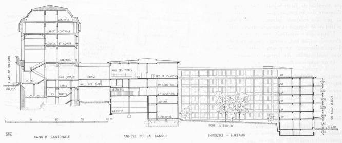
Fig. 3. — Coupe à travers les trois groupes: banque, annexe et bureaux locatifs. Echelle 1:700.
