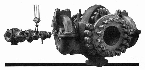
Vannes à obturateur rotatif, à double étanchéité, avec commande hydraulique par pistons cintrés, diamètre nominal 600 mm, pression de service 150 at., pression d'essai 270 at., longueur utile 2600 mm, hauteur 2100 mm, largeur 3000 mm
