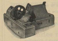
Appareil MAAG, type HM-30 à contrôler l'angle d'hélice d'engrenages hélicoïdaux.
