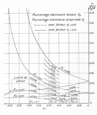
Fig. 10 d. — Phase I. Détermination de la quantité d'armature.
