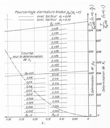
Fig. 10 c. — Phase G-H. Détermination de la position de l'axe neutre et de la quantité d'armature.
