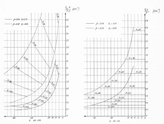
Fig. 8 c. — Phases G et H (traction). Détermination de la hauteur h (en cm).
