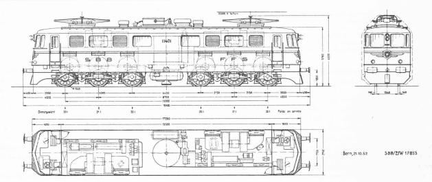
Fig. 1. — Locomotive Ae 6/6 des Chemins de fer fédéraux.
