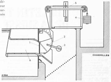
Fig. 28. — Schéma du dispositif d'essais d'un des clapets d'Öttmarsheim.
