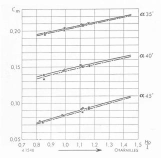
Fig. 30. — Détermination du coefficient de couple, en fonction des paramètres définis pour la figure 29. On disposait de deux movens de contrôle.
