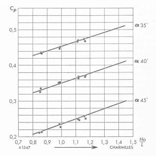
Fig. 31. — Détermination du coefficient de poussée.
