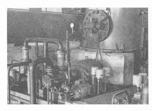
Fig. 36. — Détail d'une station de pompage, à proximité d'un accumulateur d'huile à pression d'air.
