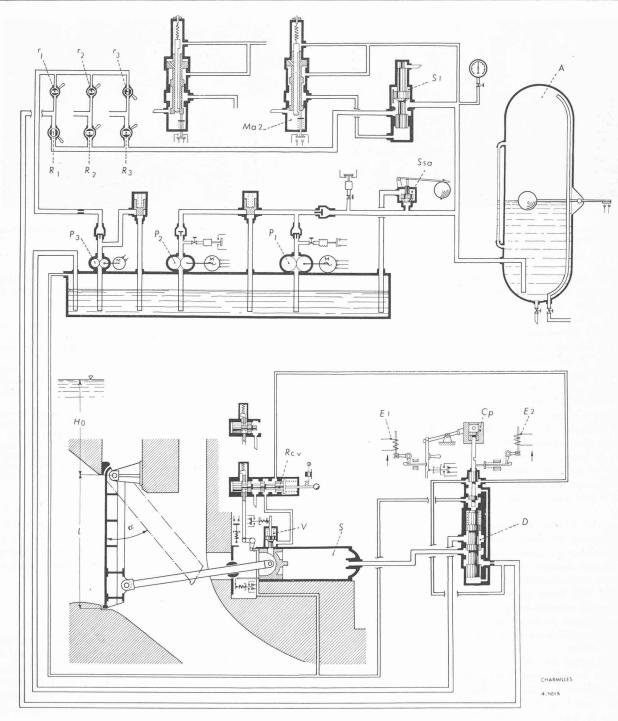
Fig. 34. — Schéma général de la commande des clapets.
