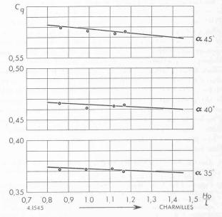
Détermination du coefficient de débit, en fonction de la charge d'eau au-dessus de l'axe du clapet, pour divers degrés d'ouverture.
