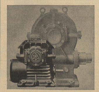
Refroidissement forcé, circulation d'huile à l'engrenage et aux roulements, profil des filets D. Brown, charge et rendement élevés malgré dimensions réduites, moins cher pour pulssance donnée que réducteur à vis ordinaire, sûr, silencieux
