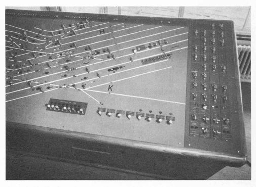
Fig. 10. — Genève-Cornavin, Poste I: Vue de détail du pupitre de commande Integra. On voit à droite du pupitre une partie des leviers individuels de secours de commande des aiguilles. Ces leviers sont plombés.
