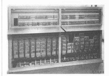
Fig. 6. — Le Locle-Ville: Vue de dos du pupitre de commande. Dans la partie supérieure, les fusibles de contrôle et des circuits d'asservissement et, en dessous, les boîtes des câbles-rapport descendant au local à relais.
