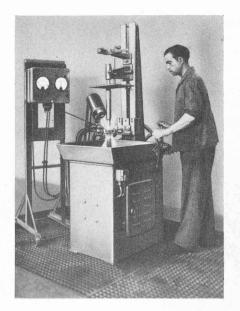
Fig. 9. — Machine à tremper verticale, avec milliscope.
