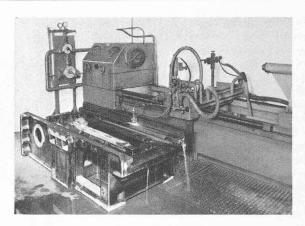
Fig. 6. — Trempe du bâti d'une presse à imprimer sur machine à tremper universelle.
