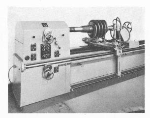
Fig. 5. — Trempe d'une vis sans fin pour engrenage sur la machine à tremper nniverselle.
