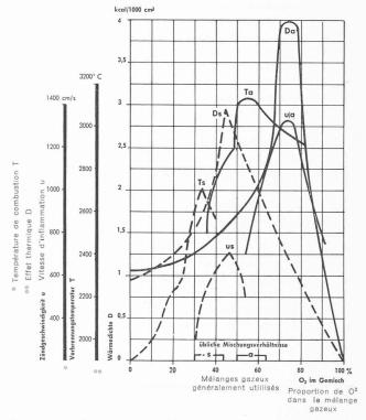
Fig. 1. — Influence du mélange gaz combustible-oxygène sur l'effet thermique (D), la température de combustion (T) et la vitesse d'inflammation (u), lors de l'emploi d'acétylène (a) et de gaz de ville (s).
