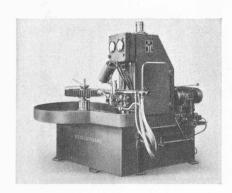
Fig. 8. — Machine automatique à tremper les roues dentées.
