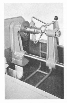
Fig. 11. — Trempe d'un boulon d'accouplement sur machine à tremper les arbres.
