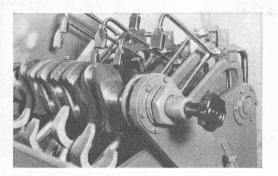
Fig. 2. — Machine à tremper les vilebrequins.
