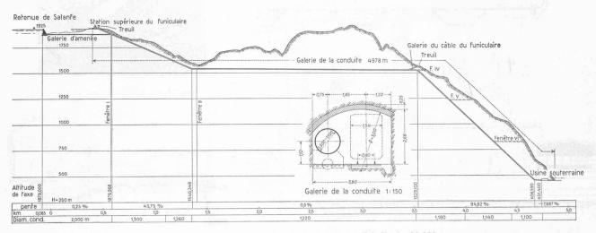
Fig. 21. — Profil en long de la conduite. — Echelle 1 : 30 000.
