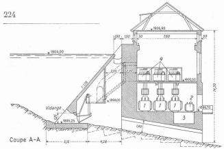
Fig. 6. — Coupe par la vanne et le canal de purge.
