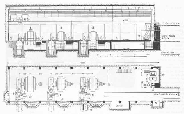
Fig. 27. — Centrale souterraine de Miéville. Elévation et plan. — Echelle 1:400.
