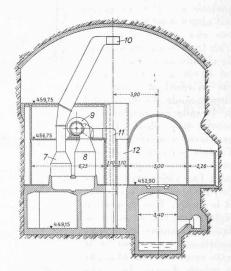
Fig. 29. — Coupe au droit des installations de climatisation.
