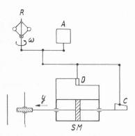
Fig. 2. — Principe d'un réglage accéléro-tachymétrique avec asservissement.
