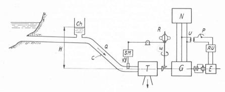
Fig. 1. Principe de la disposition d'un groupe hydro-électrique avec chambre d'équilibre.
