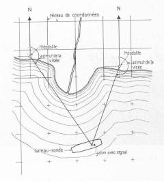
Fig. 7. — Détermination de la situation.
