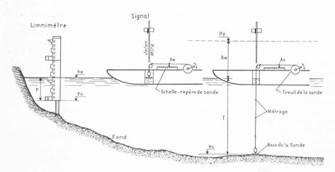
Fig. 1. Représentation schématique de la mesure de la profondeur. (La des-tination du signal est expliquée au chapitre II.)
