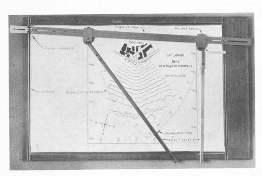
Fig. 8, — Appareil à dessiner.
