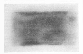
Fig. 7. — Photographie d'un champ ultrasonore. Le champ émis par un cristal n'est pas uniforme. Des irrégularités apparaissent ainsi qu'un quadrillage décelant des vibrations parasites du cristal.
