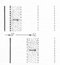
Fig. 1. — Formation d'une onde. La couche comprimée à gauche, se met en mouvement mais est progressivement arrêtée par la couche suivante à laquelle elle transmet pression et vitesse.
