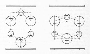
Fig. 5. — Piézoélectricité du quartz. Sous l'influence du champ électrique, les ions sollicités se déplacent; la fibre est déformée transversalement.
