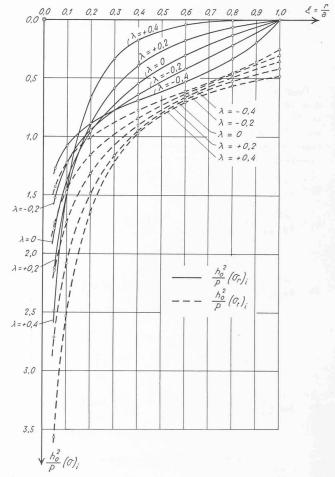
Fig. 14. — Plaque circulaire posée de la figure 11 a ou 11 b. Représentation graphique de  $(\sigma_r)_i$  et  $(\sigma_t)_i$  en fonction de  $\xi = \frac{r}{a}$ , pour différentes valeurs de  $\lambda$  ( $\nu = 0.25$ ).
