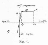
plastique. Ce dernier suppose (fig. 1) que la matière est complètement élastique jusqu'à la limite d'élasticité qui correspond alors à la limite d'écoulement (fluage); au-delà de cette limite et jusqu'à un point correspondant à l'accroissement de résistance naturelle, il y aura augmentation des déformations sans augmentation des tensions. Le même
