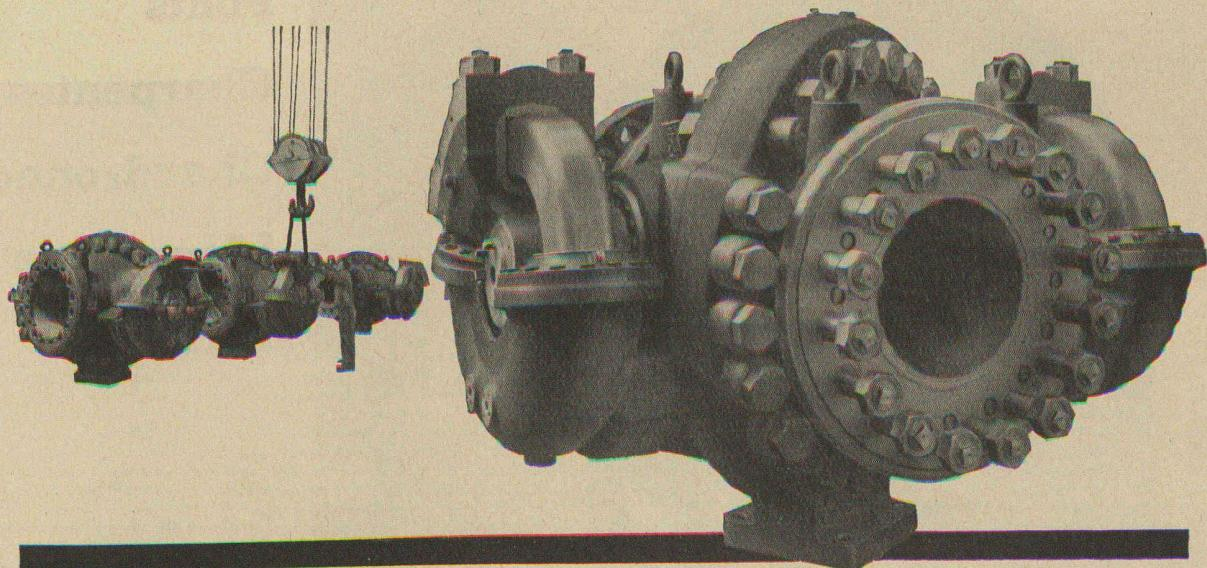
Vannes à obturateur rotatif, à double étanchéité, avec commande hydraulique par pistons cintrés,
