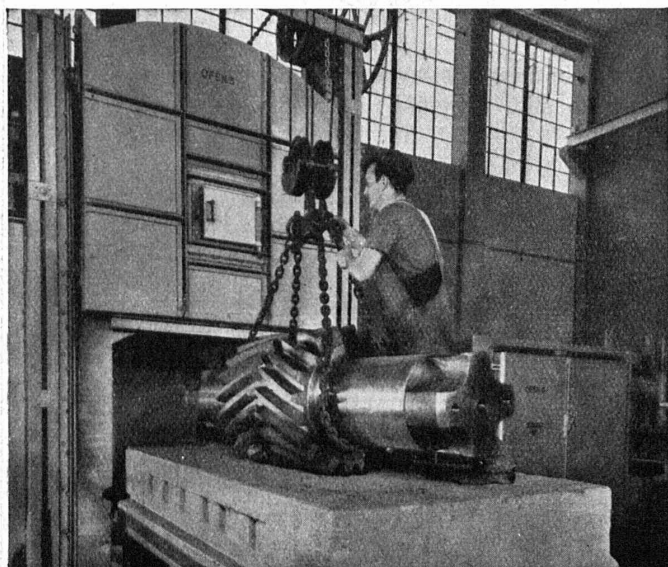
Chargement d'un four électrique à recuire d'un pignon à denture double-hélicoïdale
