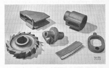
Fig. 9. — Quelques produits typiques de la fonderie de précision.
