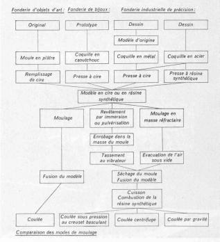
Fig. 1. — Comparaison des procédés de fonderie de précision.
