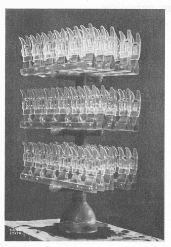
Fig. 3. - Modèles assemblés, prêts au moulage.
