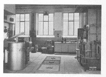
Fig. 12. — Fours et bains de trempe en fosse pour traitements thermiques.
