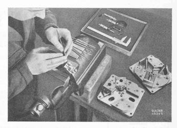
Fig. 2. — Fabrication d'une coquille en acier.
