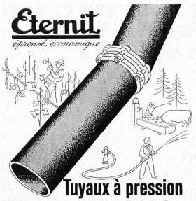
pour captages, conduites d'hydrants et d'irrigation. Diamètres de 50 à 400 mm, pression d'essai jusqu'à 24 atm. Ne rouillent pas et ne sont pas sujets à la corrosion. Parois internes lisses avérant une résistance minime à l'écoulement. La grande élasticité de l'amiante-ciment garantit la résistance aux coups de bélier. Pose facile, les joints flexibles permettent une légère déviation des tuyaux.
