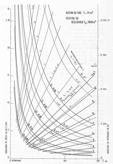
Fig. 4. — Variation du plan d'eau dans le tube et le réservoir en fonction de la section de l'ouverture différentielle S, de la période des oscillations dans le tube T et des variations de débit  $Q_v$  au bas de la chambre.
