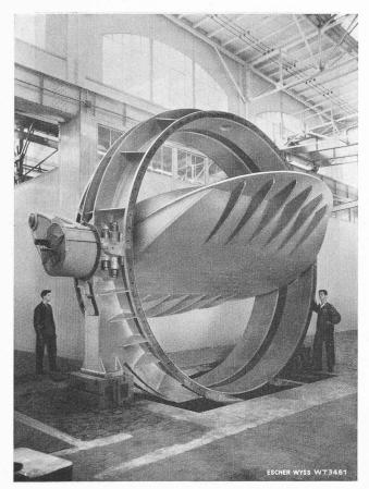
Fig. 37. — Vanne de garde des conduites forcées.
