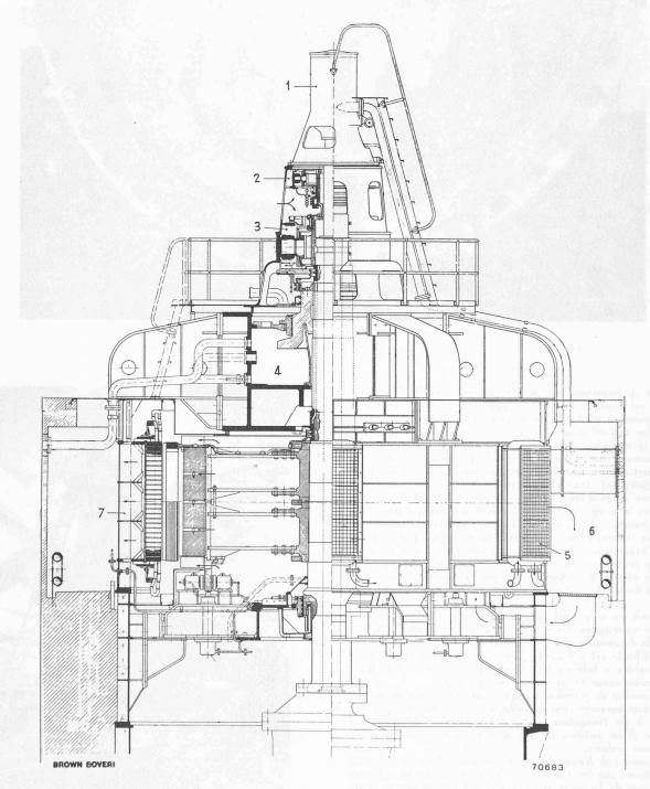
Fig. 45. — Vue en coupe d'un alternateur triphasé de 29 400 kVA, 10 000 volts, 214 t/min., de l'Usine de Lavey.
