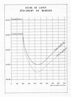
Fig. 20. — Règlement du barrage.
