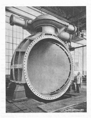
Fig. 38. — Vanne-papillon des turbines Charmilles, Ø 4200 mm.
