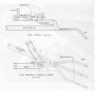
Fig. 23. — Modèle de la chambre d'équilibre. Echelle 1:100.
