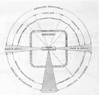
Fig. 59. — Diagramme de la salle de commande de l'usine de Lavey.
