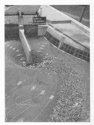
Fig. 22. — Essais sur modèles réduits exécutés au Bois-Noir. Aspect de la retenue après un charriage en année moyenne.
