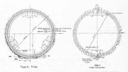
Fig. 12 a. — Profils-type de la galerie d'amenée. — Echelle 1 : 200.
