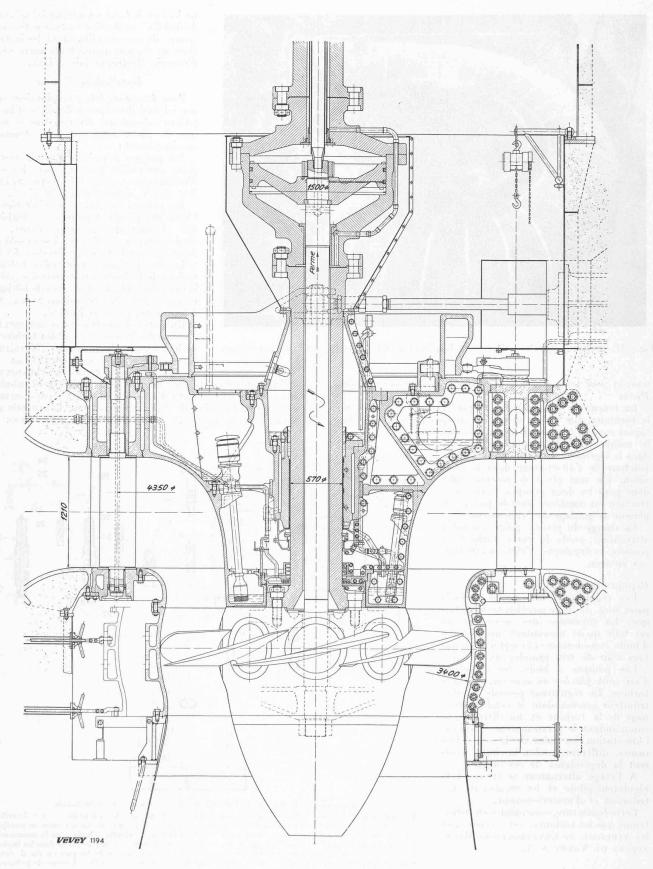
Fig. 40. — Coupe transversale de la turbine Kaplan, Vevey.
