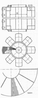
Fig. 52. — Circuit magnétique d'un transformateur monophasé du type cuirassé avec tôles disposées radialement.
