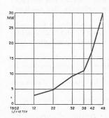
Fig. 3. — Charge maximum annuelle du réseau de distribution.
