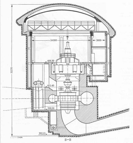
Fig. 17. — Coupe transversale de la salle des machines souterraine Les alternateurs sont encastrés dans le sol. Seuls le croisillon supérieur et les excitatrices sont au-dessus du plancher de la salle des machines. Cette disposition des alternateurs a permis de réduire au minimum la hauteur du crochet du pont roulant.
