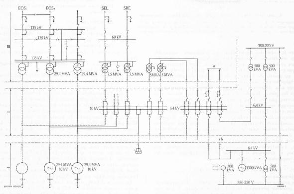
Fig. 19. — Schéma général unifilaire de l'usine de Lavey.
