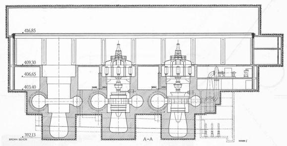
Fig. 16. — Salle des machines souterraine.. — Coupe longitudinale.
