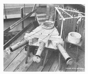
Fig. 27. — Modèle du répartiteur pour essais d'écoulement à l'air.
