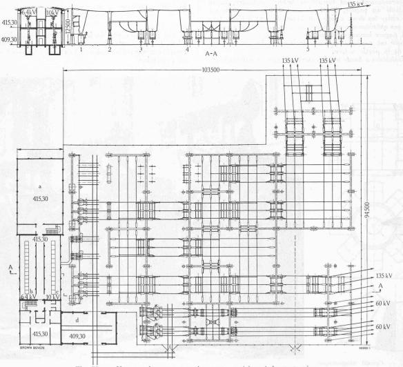
Vue en plan et coupe du poste extérieur à haute tension.
