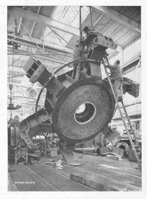
Fig. 48. — Montage en atelier des bras du croisillon supérieur d'un alternateur.
