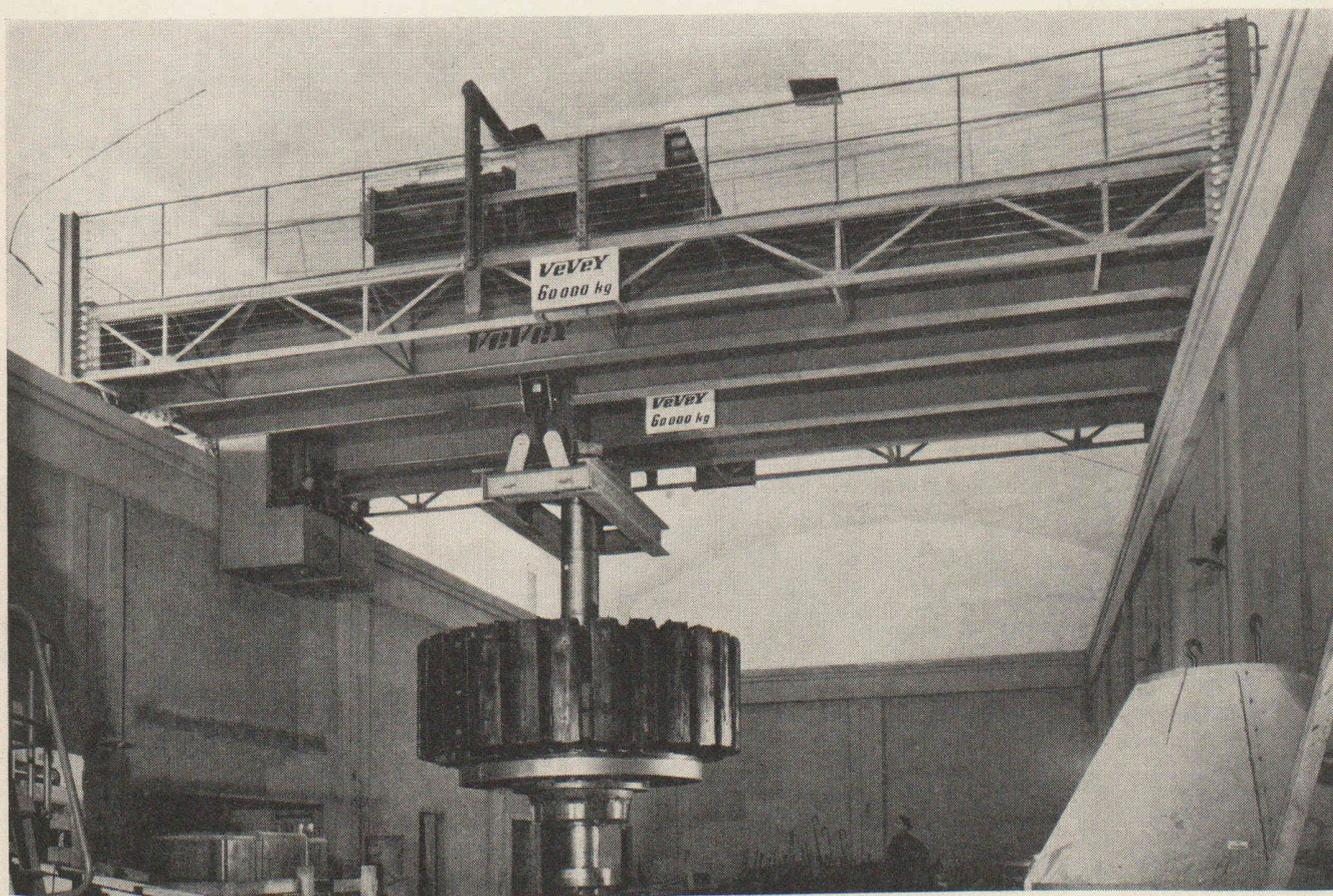
Les deux ponts roulants de l'Usine de Lavey livrés par les Ateliers de Constructions Mécaniques de Vevey S. A.,
