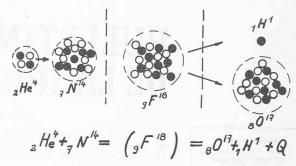
Fig. 2. — Exemple de réaction nucléaire. Un noyau d'hélium (particule α) accéléré entre en collision avec un atome d'azote. Le noyau intermédiaire formé (fluor) est très fortement excité et, après une durée de vie négligeable, expulse un noyau d'hydrogène proton) et donne naissance à un noyau d'oxygène de masse 17.
