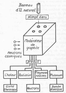
Fig. 5. — Principe d'un réacteur à modérateur de graphite. Les barreaux d'U. sont disposés en un réseau spécialement étudié dans la masse du graphite et sont protégés par une gaine spéciale d'aluminium permettant le passage du liquide réfrigérant. Les barreaux de matière absorbant les neutrons peuvent être déplacés à l'intérieur du réacteur et permettent de contrôler la réaction et le niveau de température.
