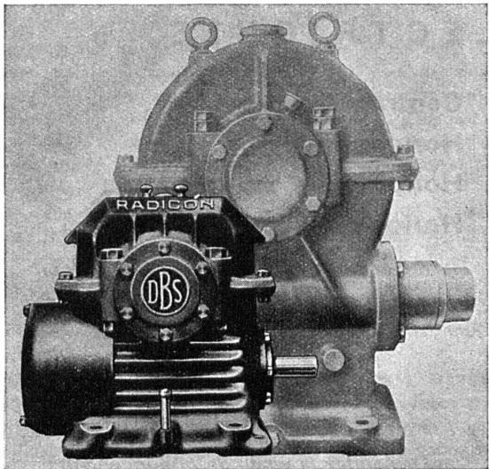
Réfrigération forcée, circulation d'huile à l'engrenage et aux roulements, profil des filets D. Brown, charge et rendement élevés malgré dimensions réduites, moins cher pour puissance donnée que réducteur à vis ordinaire, sûr, silencieux.
