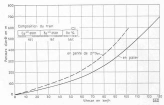
Fig. 20. — Parcours d'arrêt du train d'essai.
