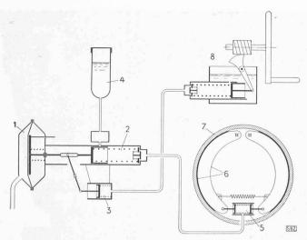
Fig. 16. — Schéma de principe du frein oléo-pneumatique.
