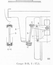
1, barre de torsion; 2, point fixe; 3, palier; 4, levier; 5, bielle; 6, console de la caisse; 7, amortisseur; 8, chandelle de pivot; 9, guide de pivot; 10, amortisseur.
