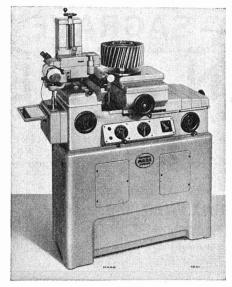
Machine MAAG à contrôler les engrenages, type PH-60
