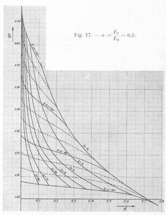
Fig. 16 et 17. — Arc élastique mince sur appuis élastiques déformables. Effet d'une pression hydrostatique uniforme. Coefficient hyperstatique K et ordonnée relative  $\eta_s$  du centre élastique pour les valcurs 1 et 0,5 du rapport des modules d'élasticité  $n=\frac{E_r}{E_b}$ .
