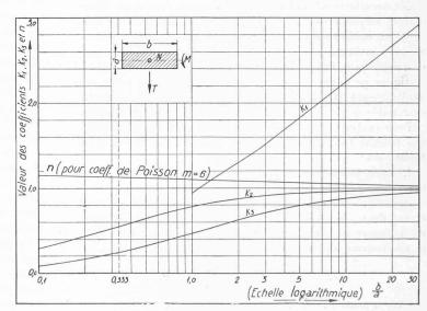
Fig. 10. — Coefficients de déformation du rocher (d'après Vogt).
