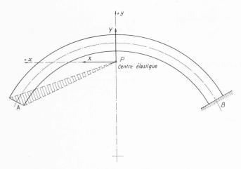
Système d'axes de référence avec le centre élastique P de l'arc pour origine.
