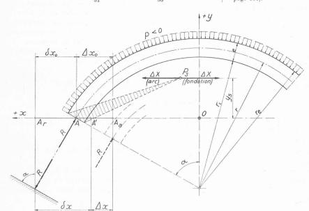
Fig. 15. — Arc élastique mince sur appuis élastiques déformables.
