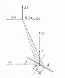
Fig. 14. Système d'axes de référence rapporté à la fondation rocheuse.
