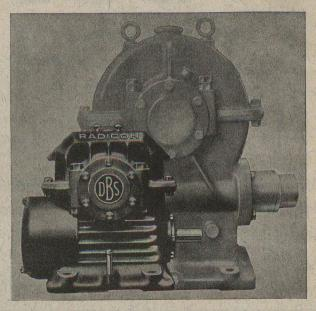
Refroidissement forcé, circulation d'huile à l'engrenage et aux roulements, profil des filets D. Brown, charge et rendement élevés malgré dimensions réduites, moins cher pour puissance donnée que réducteur à vis ordinaire, sûr, silencieux.
