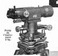
La lunette, très soigneusement montée, est 'dotée d'une 'nivelle réversible. La vérification de l'instrument s'effectue de suite, à partir d'une unique station, en faisant tourner la lunette autour de l'axe longitudinal.
