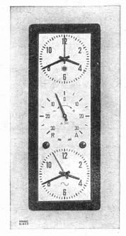
Appareil indiquant le décalage de la fréquence d'un courant alternatif par rapport à l'heure normale
