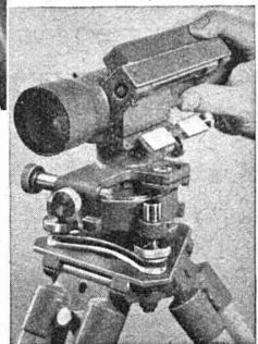
La lunette, très soigneusement montée, est dotée d'une lunette réversible. La vérification de l'instrument s'effectue de suite, à partir d'une unique station, en faisant tourner la lunette autour de l'axe longitudinal.
