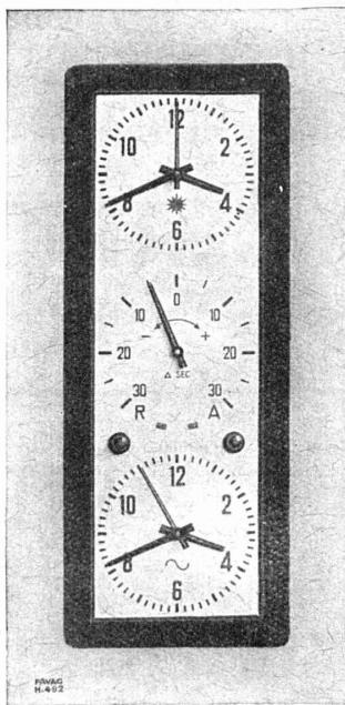
Appareil indiquant le décalage de la fréquence d'un courant alternatif par rapport à l'heure normale
