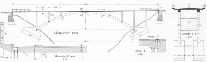
Fig. 3. — Pont de Laxgraben. Disposition générale.
