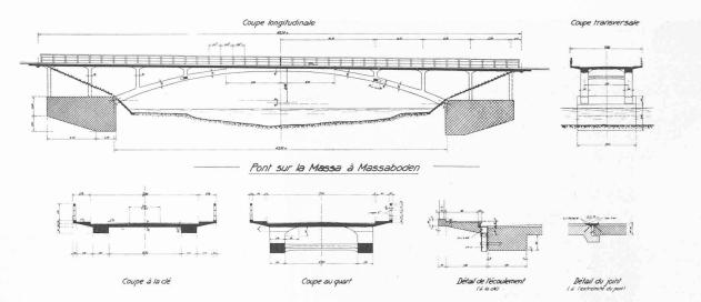
Fig. 6. — Pont sur la Massa. Dispositions générales.
