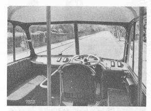
Fig. 2. - La place du conducteur du gyrobus.
