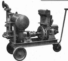
Débits de 1 à 500 litres/seconde. - Pas de soupape de pents de 1 a 500 litres/seconde. — Pas de soupape de pied, ni de clapet dans la tubulure d'aspiration. — Aucune pompe à vide de secours. — Réamorçage automatique immédiat, même si de l'air est entré dans le tuyau d'aspiration. — Pas de surfaces de contact à frottement et s'usant; par conséquent pas de contretemps même pour l'élévation de la boue, du sable ou du gravier.
