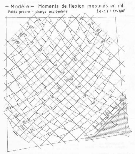
Fig. 10. — Essai sur modèle réduit. Moments mesurés pour  $q=g+p=1{,}15$  t.
