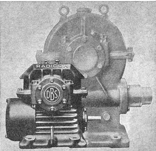
Refroidissement forcé, circulation d'huile à l'engrenage et aux roulements, profil des filets D. Brown, charge et rendement élevés malgré dimensions réduites, moins cher pour puissance donnée que réducteur à vis ordinaire, sûr, silencieux.
