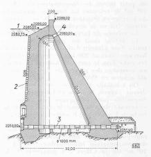
Fig. 15. — Barrage de l'Inferno. Coupe d'un élément du barrage évidé. Echelle 1 : 800.
