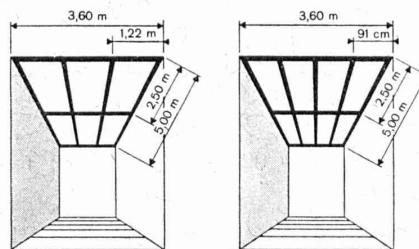
Voici, à titre d'exemple, un plafond de chambre de 3,6 sur 5,0 m, divisé en 6 panneaux de 122 x 250 cm (à gauche) et en 8 panneaux de 91 x 250 cm (à droite).
