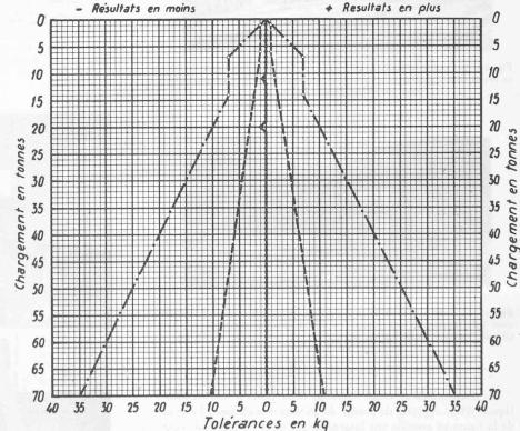
\_\_\_\_ Tolérances suivant le règlement des Poids et Mesures Suisse \_\_\_\_ Tolérances des CFF; \_\_\_\_\_ Tolérances obtenues
