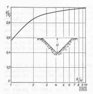
Fig, 5. — Comparaison entre un barrage-poids-voûte et un barrage-poids massif pour un profil en V, Ordonnées: rapport des volumes  $V/V_0$  Abcisses: rapport R/H.
