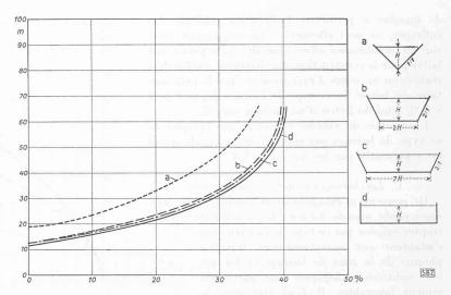
Fig. 3. — Economie possible en volume de béton pour le cas d'un barrage évidé du type « Bau Muggeris » par rapport à un barrage-poids-massif de même hauteur et pour différents profils de vallées  $(a,\ b,\ c,\ d)$ .
