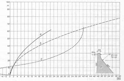
Fig. 2. — Comparaison entre les volumes d'un élément d'un barrage évidé type « Bau Muggeris » et d'un élément de même largeur d'un barrage poids-massif.
