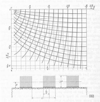
Sollicitation du sol de fondation d'un barrage évidé. En bas, schéma de charge; en haut, isostatiques.
