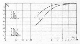
Fig. 4. — Comparaison entre barrage-poids-voûte et barrage-poids massif,
