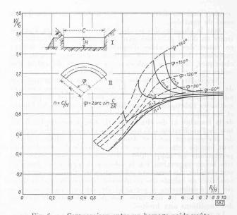
Fig. 6. — Comparaison entre un barrage-poids-voûte et un barrage-poids massif pour un profil en U. Ordonnée: rapport des volumes  $V/V_0$ . — Abcisse: rapport R/H; paramètre n = C/H. — V volume du barrage-poids-voûte. —  $V_0$  volume du barrage-poids massif. — R rayon de courbure du barrage-poids-voûte. — I coupe longitudinale du barrage. — II vue en plan du barrage.
