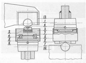
Fig. 11. — Coussinets à billes pour la communication entre les leviers d'angle et les leviers intermédiaires du pont à bascule de 50 t, selon figures 2 et 3.
