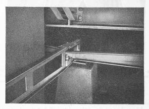
Fig. 7. — Point d'appui des deux leviers intermédiaires sur le levier communicateur du pont à bascule de 50 t, selon figures 2 et 3.
