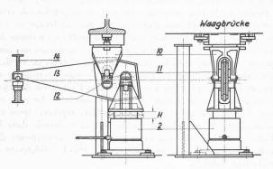
Fig. 5. — Supports à billes pour un pont à bascule pour wagons, capacité de pesage 50 t, sans interruption de voie, avec presse hydraulique et levier d'angle.
