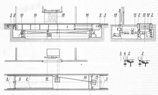
Fig. 3. — Pont à bascule, pour wagons, capacité de pesage 50 t, sans interruption de voie, avec calage hydro-électrique, rampes d'accès mobiles, jeu de leviers en construction sans torsion, avec couteaux réglables et interchangeables, brevet Giroud.
