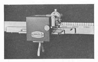
Fig. 14. — Poids-curseur du fléau du pont à bascule de 50 t, selon figure 2 et 3, muni d'une protection automatique des entailles, selon brevet n° 227 173 et d'un appareil d'imprimeur à tickets pour l'enregistrement des poids bruts et de la tare.
