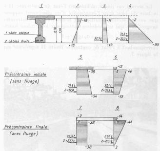
Fig. 13. — Diagrammes des contraintes de flexion dans la section médiane d'une poutre principale en kg/cm².
