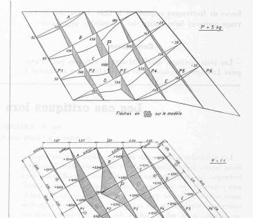
Fig. 19. — Diagrammes des déformations et des moments fléchissants déterminés sur un modèle au Laboratoire de statique de l'EPUL.
