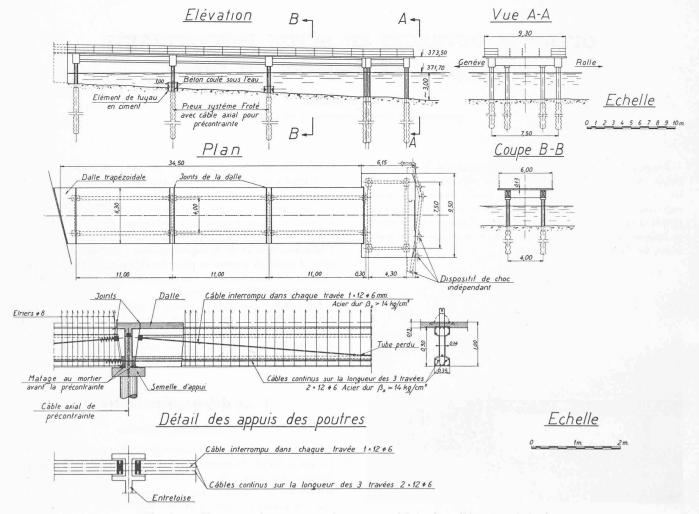
Fig. 3. — Plan, élévation et coupe du nouveau débarcadère. (Lire  $\beta_{z} < 14~t/cm^{2}$ ).
