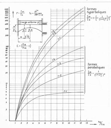
Fig. 5. — Charge uniformément répartie. Influence du rapport  $h_{\epsilon}/h_m$  sur la flèche  $f_m$ .
