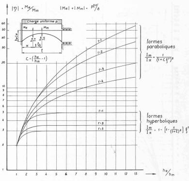
Fig. 4. — Charge uniformément répartie. Influence du rapport  $h_e/h_m$  sur le rapport  $M_e/M_m$ .
