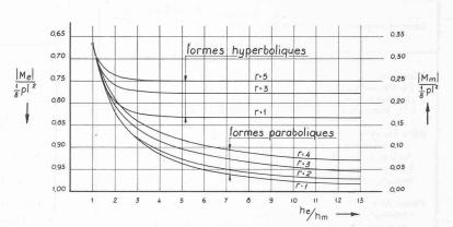
Fig. 15. — Charge uniformément répartie. Moments fléchissants à l'encastrement  $M_e$  et au milieu de la portée  $M_m$ , rapportés au moment fléchissant maximum de la poutre à deux appuis simples.
