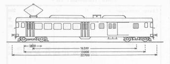
Fig. 1. — Diagramme de l'automotrice CFe 44 des C.F.F.
